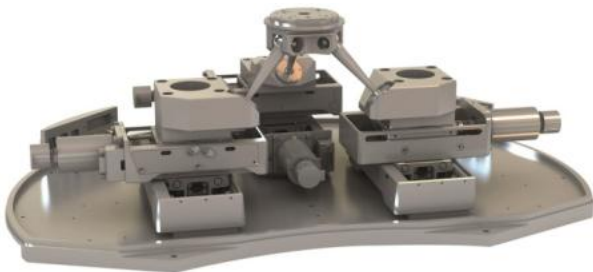
Abb. 7 Im Gegensatz zur seriellen Kinematik wirken bei parallelkinematischen Systemen alle Aktoren unmittelbar auf die gleiche Plattform, es können sich also nicht wie bei „gestapelten“ Systemen Führungsfehler summieren, dadurch ist die Genauigkeit deutlich höher (Bild: PI)
